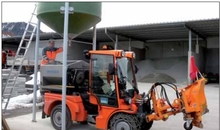
Salzsilo zur leichteren Befüllung des Aufsatzsalzstreuers bei unserem AEBI
