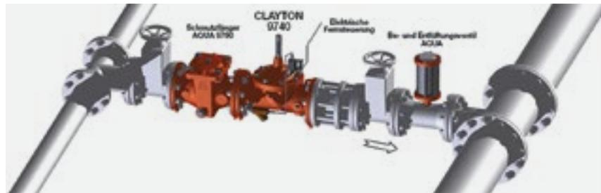
Druckreduzierung mittels Clayton-Ventil
