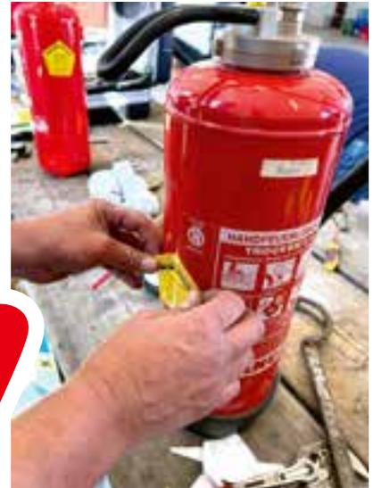
**Feuerlöscher sind alle zwei Jahre von geprüften und zugelassenen Löscherwarten zu überprüfen!**
